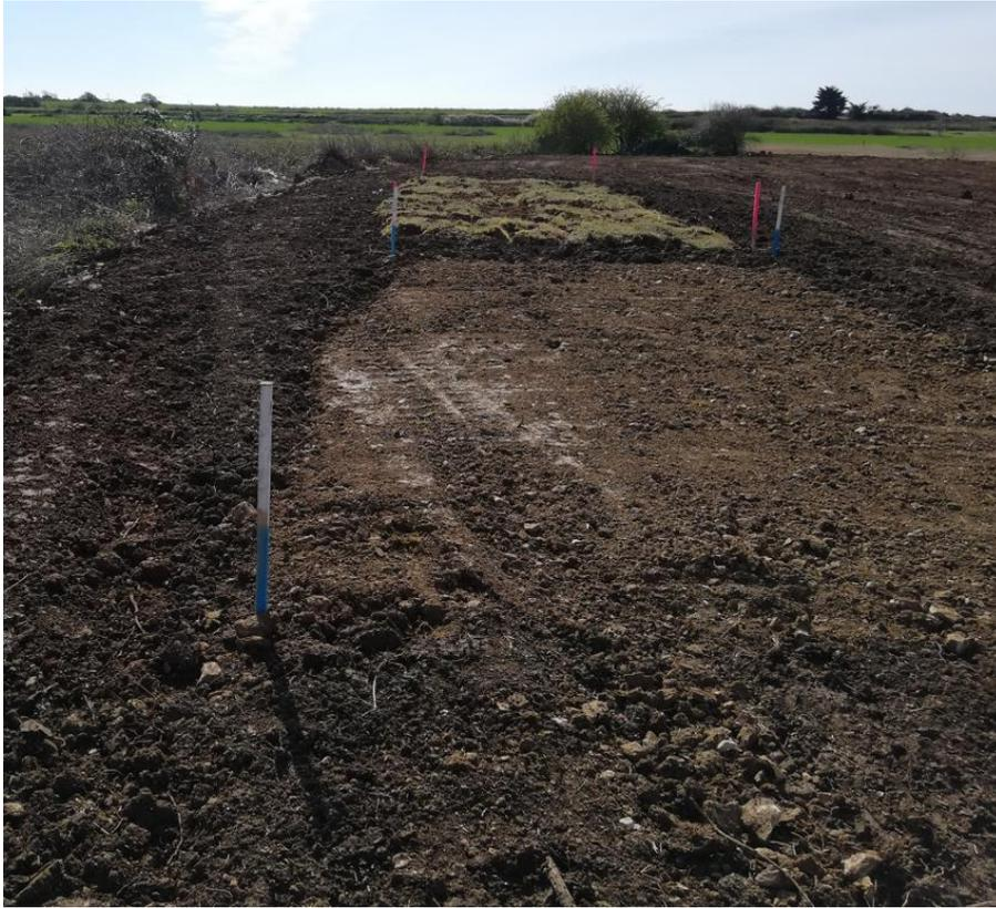
Figure 21. Zone test avec du sol en vrac au premier plan et les plaques de sol au second plan
